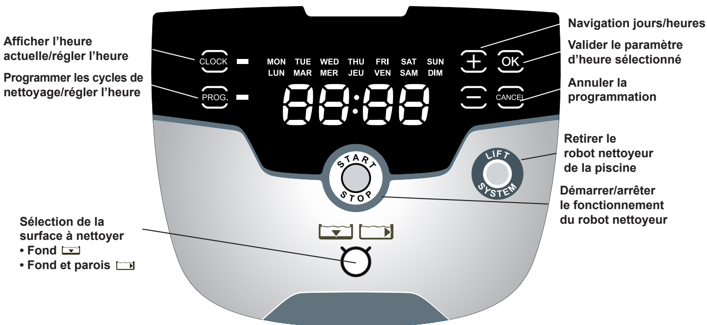
Figure 16. Fonctions du module de commande du 9400 4WD / P94 4WD
