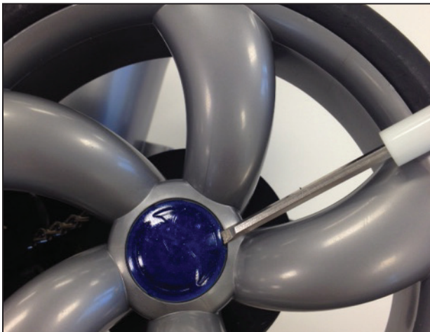
Figure 10. Retirer les enjoliveurs des roues doubles latérales
