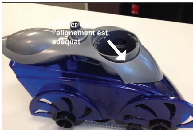
Figure 21. Parties arrière et supérieure du boîtier alignées
