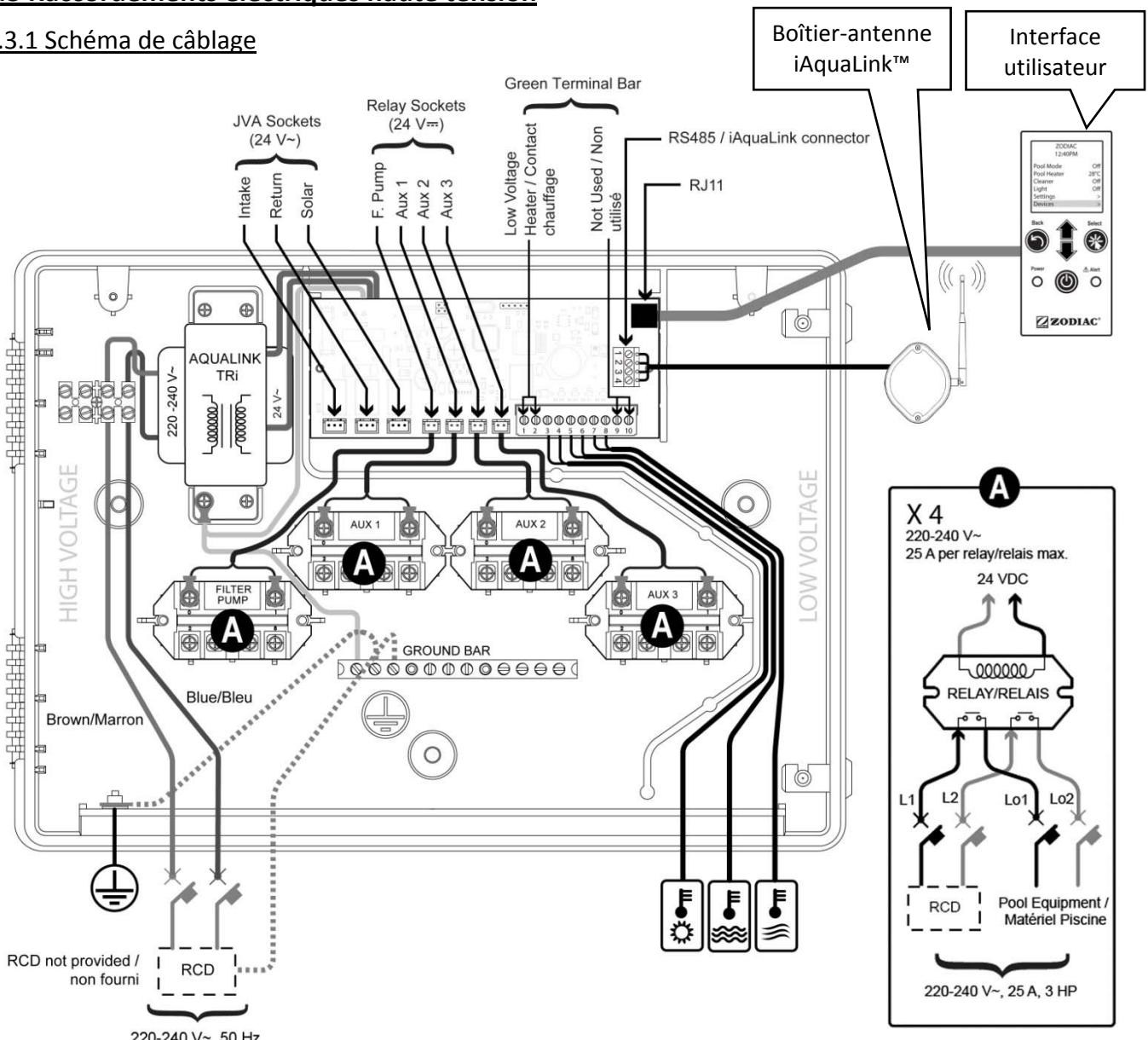
« RCD » (= Residual Current Device) : dispositif de protection différentielle.
