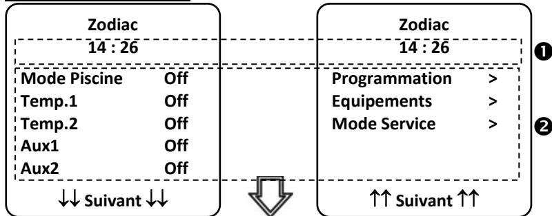
① La deuxième ligne de l'écran affiche en alternance l'heure, la température de l'air, la température de l'eau (si la filtration est en marche), la température solaire (si la fonction est activée) et les messages d'alerte éventuels.
